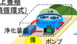
○成分を調整した水道・井戸水を循環利用し、浄化装置により養殖水槽の水質を一定に保つ
